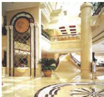
图3-26 用花岗岩、大理岩 石材作为建筑物的内表面装饰
