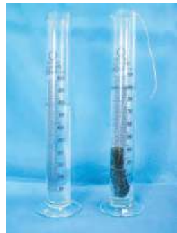
图1-48 用排水法测量不规则物体的体积
